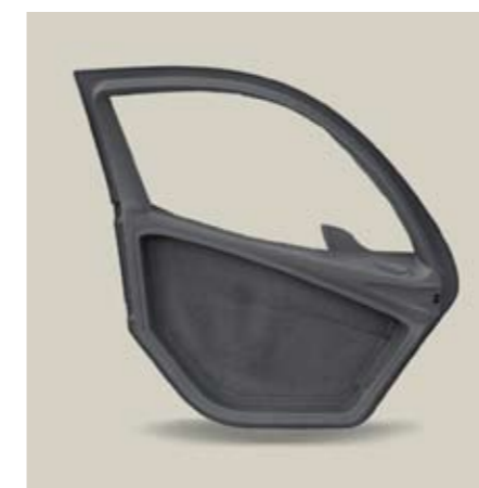
TÜR FÜR ROLLERMOBIL, KOMPLETT MIT METALLEINSÄTZEN: Innen- und Außenteile mit strukturellen Klebern montiert. Tür besitzt die gleiche dimensionale Stabilität und Beständigkeit von Metalltüren, weist jedoch wesentlich weniger Gewicht auf.
