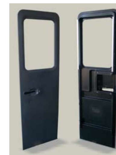
WOHNZELLENTÜR FÜR CAMPER: besteht aus zwei mit strukturellen Klebern verbundenen Gehäusehälften. Grauer Gelcoat auf der Außenseite. Gesamtgewicht mit Einsätzen: 7,5 kg.
