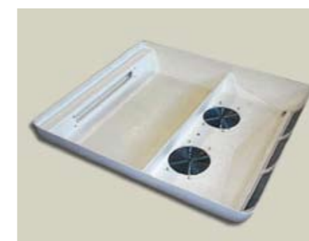
KLIMAGERÄT-ABDECKUNG: bestehend aus vier Teilen und sechzehn Metalleinsätzen, die mit strukturellen Klebern verbunden werden.
